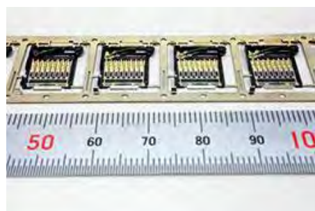
製品：マイクロSDカード 高精度フープ成形金型設計制作
