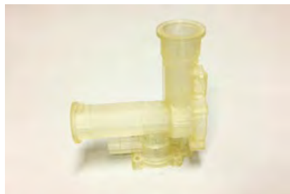
製品：ポンプモータ 素材：※光造形 成形品
